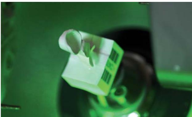
Abb. 6: Geschliffenes Brückengerüst aus VITA In-Ceram YZ.
