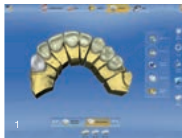
Abb. 1 Das Design der CoCr-Kronen- und Brückengerüste, die aus dem Sintermetall Crypton gefertigt werden sollen, erfolgte mit der inLab Software 4.2 von Sirona
