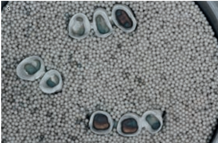
Abb. 3 Die Crypton-Gerüste im Sinterbett nach dem Dichtsintern – an den Lücken um die Objekte herum lässt sich die kontrollierte Schrumpfung erkennen
